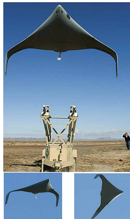
Bezpilota lidaparāts «Killer Bee» un tā palaišanas platforma.
