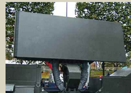
GM400 sastāvdaļa — radara antena.
