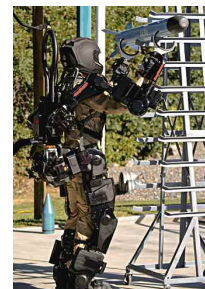
Karavīrs, ietērpts eksoskeletā «XOS2», trenējas smagumu celšanā.
