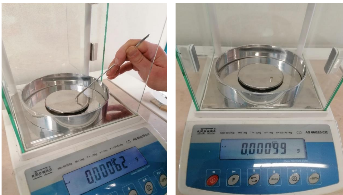
Figure 2.29 e 2.30 Fase di riempimento della capsula di stagno e pesatura nella bilancia a cinque cifre decimali
